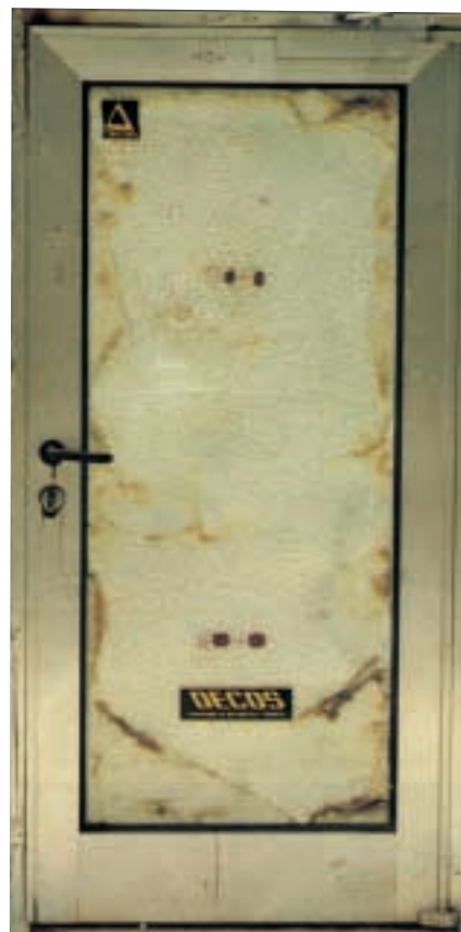
Porta Igniglas REI 60 tipo 1 dopo il test di prova
