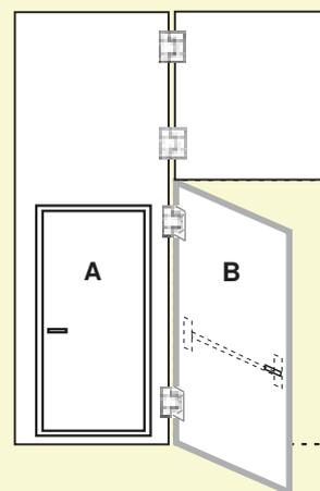
A - Portina pedonale di CORTESIA inserita, con zoccolo a pavimento, completa di maniglia e serratura.
