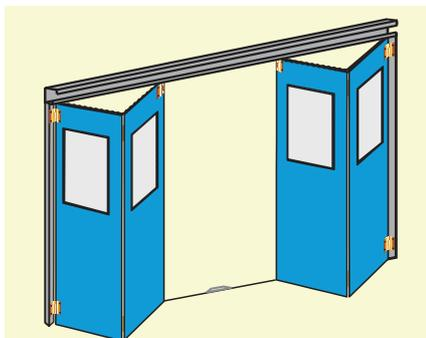
DELTOR FRP a più ante con apertura a libro in uno o due battenti incernierati sui montanti laterali, ante spessore mm 52, cerniere di grandi dimensioni. Guarnizioni di tenuta in EDPM. Chiusura a cariglione dall'interno (a richiesta chiusura dall'esterno con chiave, solo con manovra manuale).
