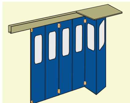
DELTOR FLP scorrevole ad impacco laterale in uno o due battenti con sospensione alla guida superiore, ante spessore mm 52, cerniere di grandi dimensioni. Guarnizioni di tenuta in EDPM. Guida inferiore a canaletta. Chiusura a cariglione dall'interno (a richiesta chiusura dall'esterno con chiave, solo con manovra manuale).
