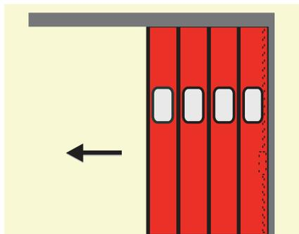
DELTOR FDP a scorrimento diritto in uno o due battenti guida portante a terra o con sospensione alla guida superiore, ante spessore mm 52. Guarnizioni di tenuta in EDPM. Chiusura a cariglione dall'interno (a richiesta chiusura dall'esterno con chiave, solo con manovra manuale).
