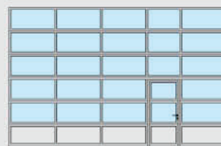
Disposizione portina pedonale inserita a destra
