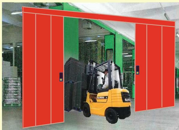
**02 - 30 IGNISCO** chiusure tagliafuoco a scorrimento laterale REI 120, ad una o due ante realizzate con pannellature modulari in lamiera pressopiegata, a deformabilità programmata, per formare un sandwich coibentato, comprendente: chiusura a mezzo fusibile termico, guida di scorrimento, guarnizione termoespandente e verniciatura antiruggine colore pastello turchese tonalità chiara con finitura liscia semilucida non goffrata.
